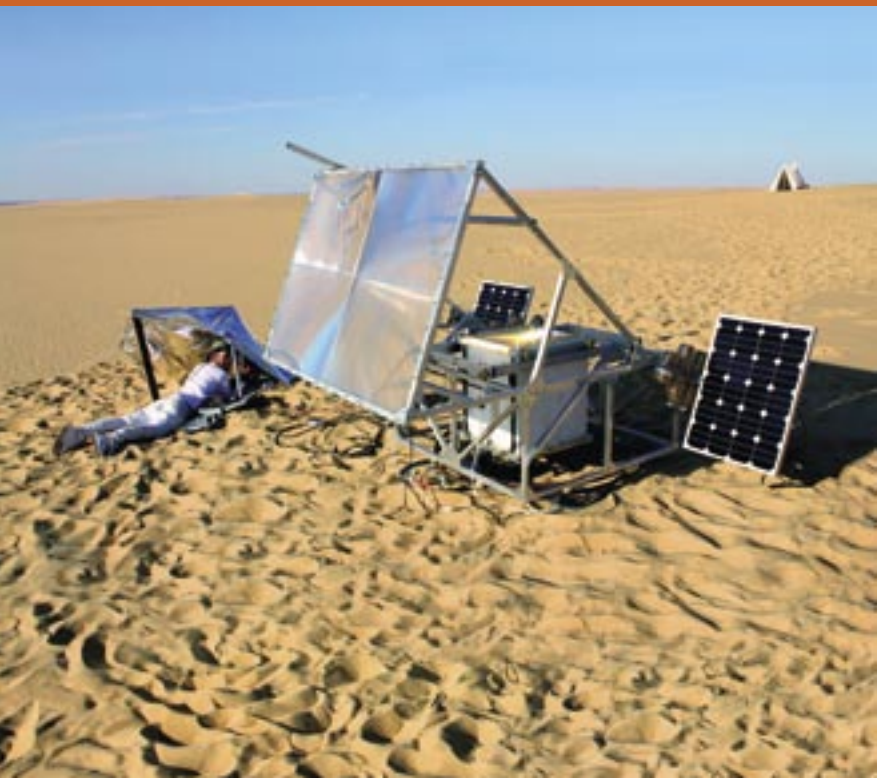
Markus Kayser: Solar Sinter Project, 2011, zariadenie na čerpanie solárnej energie a 3D tlač
